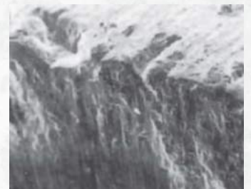
U klasické oceli dochází v místech shluků karbidů k mikroskopickému vydrolení resp. makro-skopickým výlomům.
